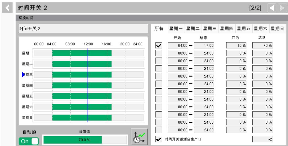
图 14-9：模拟时间开关参数设置
